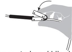
8 Napsauta kansi kiinni, varmista että kaikki neljä hakasta kiinnittyvät.
