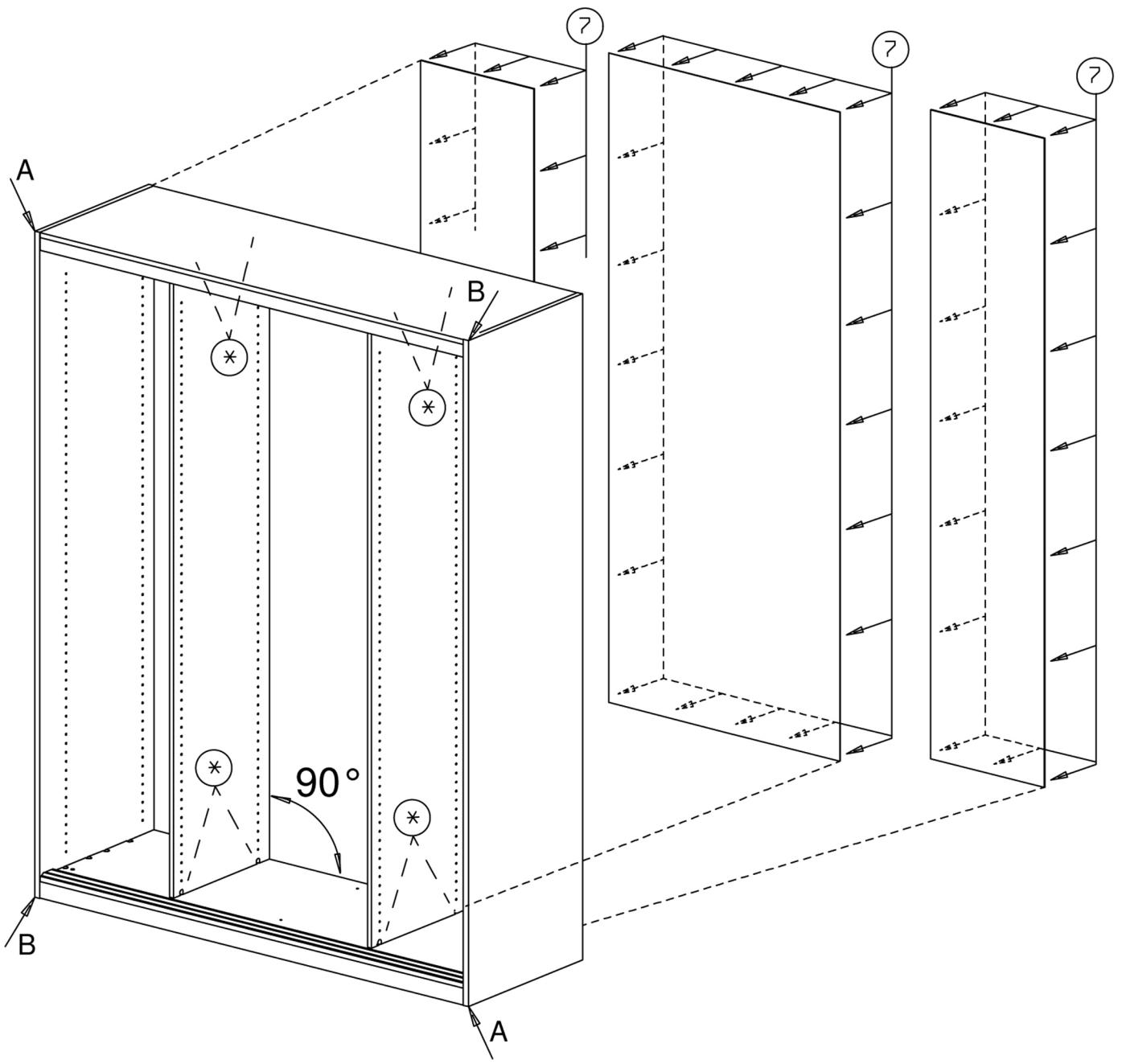
Tarkista suoruuus "ristimittaamalla" kaappi kulmasta kulmaan ennen taustalevyjen kiinnittämistä (mitta A = mitta B).
